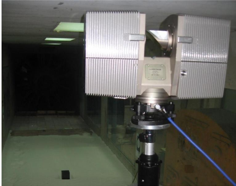
图 5.4 FARO 三维激光扫描仪示意图
