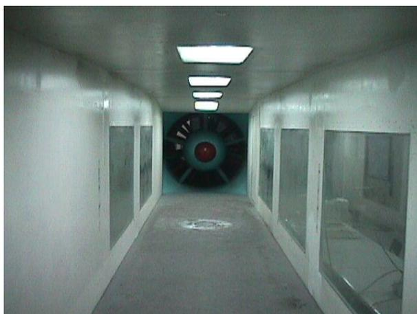
图 5.2 TJ-1 风洞试验段
