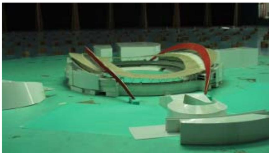
图 1.2.15 气弹模型照片
