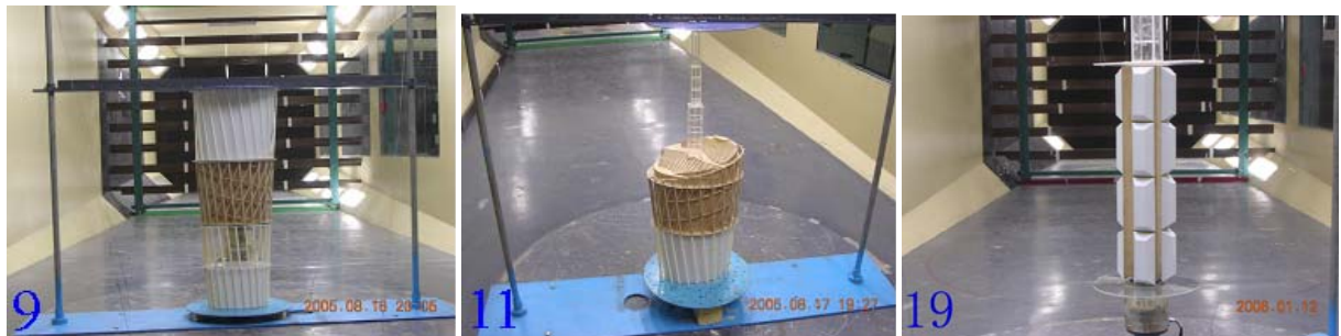
图2 风洞中节段刚体测力模型照片
