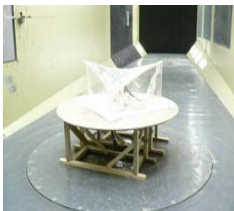
图 4.8 风洞试验模型(缩尺比 1/50)
