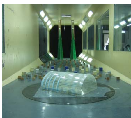
图 2.2 干燥棚风洞试验模型及风向角规定
